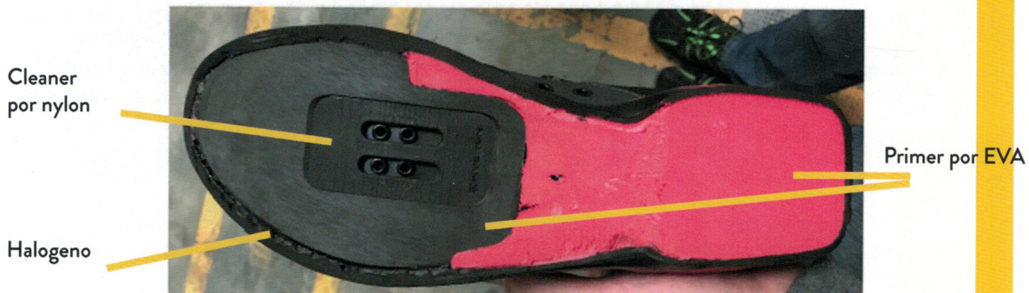
FIGURA 6 - PLANTA CON BORDE DE GOMA RESTANTE
