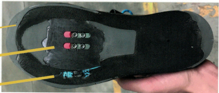
FIGURA 13 – CARDADO DE LA PLANTA QUE SACA A LA SUPERFICIE: LÁMINA DE PLÁSTICO, EVA Y GOMA.
