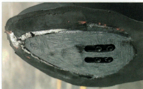
FIGURA 22 - CARDADO DE LA LÁMINA. ES NECESARIO COMPROBAR LA CONVEXIDAD DE LA ZONA
