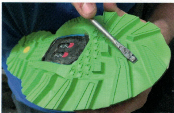
FIGURA 3 – PROCEDIMIENTO PARA ELIMINAR LAS POSIBLES BURBUJAS ATRAPADAS BAJO LA SUELA
