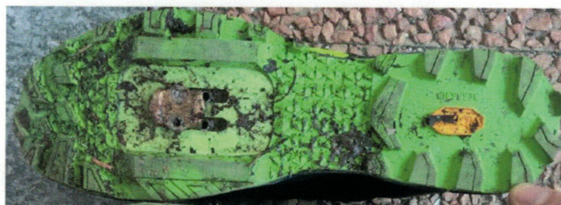
FIGURA 20 - RESOLADO ÓPTIMO CON LA ZONA DEL ENFRANQUE ESPECIALMENTE ESTRECHA
